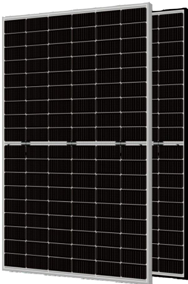
**X-TOP CON** monocristallino prevede l'introduzione di un sottile strato di ossido tra i contatti metallici e il wafer di silicio, che apporta significativi miglioramenti nell'efficienza di conversione delle celle e nelle prestazioni di generazione di energia. Basso degrado annuo.
