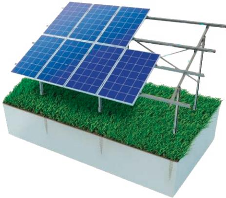
Struttura completa per superfici a terra comprensive di pali asolati da battere a terra in acciaio zincato, profili in alluminio EN AW 6060 T6 con e senza rivestimento anodizzato, viti di assemblaggio, terminali e componenti ad omega per fissaggio moduli fotovoltaici. Disposizione standard moduli (fila singola o doppia) / inclinazione 30°.
