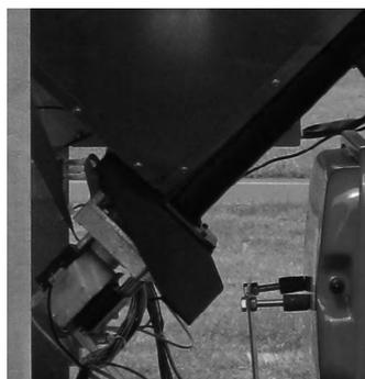
**Motoriduttore:** se il motoriduttore si ferma per la segnalazione **"ALAR-DEP-FAIL"** o **"ALAR-SIC-FAIL"** la caldaia continua a funzionare fino a quando non si spegne la fiamma per mancanza di combustibile e fino a che non raggiunge il livello minimo di raffreddamento.
