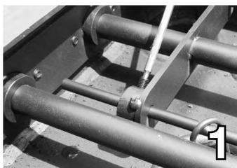
L'operazione deve essere completata svitando con un cacciavite le bussole di fissaggio (foto 1).
