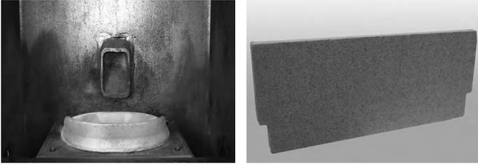
La vermiculite è un minerale dagli svariati usi nell'industria e nell'edilizia per le sue proprietà isolanti, termiche e acustiche. In questo caso la vermiculite è usata per evitare dispersioni inutili di calore. Per la sua fragilità si raccomanda di maneggiare con estrema attenzione il battifiamma durante le operazioni di pulizia della camera di combustione e di pulirlo esclusivamente con un panno morbido e asciutto.
