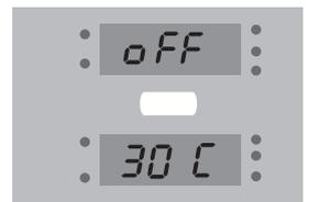
La caduta dei pellets si fermerà subito mentre la caldaia continuerà a funzionare fino al completo smaltimento del calore accumulato, spegnendosi **dopo un massimo di 30 minuti**.
